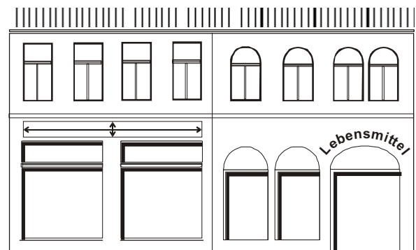
Lage von Werbeanlagen innerhalb der Fassade
