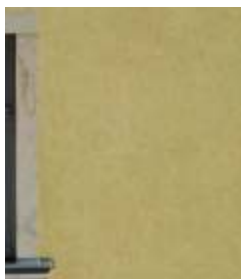
Reibeputz mit geringer Körnung - glatt verrieben
